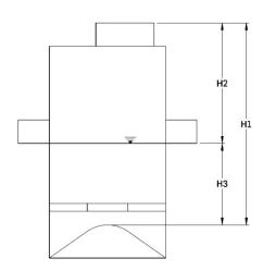
H1: distance entre le dessus du cadre en fonte et le dessus des sédiments
