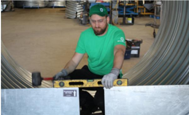
7c. À l'aide du marteau ou de la masse en caoutchouc, s'assurer que le déversoir est de niveau. Soleno recommande le port de protection auditive.
