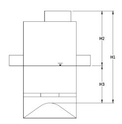
H1 : distance entre le dessus du cadre en fonte et le dessus des sédiments
