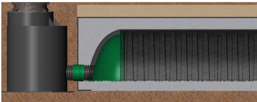
Regard d'accès, raccordement et rangée d'isolation
