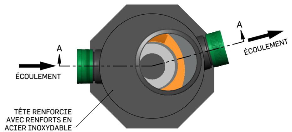
CENTRE DE L'APPAREIL DE TRAITEMENT, GRILLE DE SÉPARATION ET OUVERTURE DE LA RÉSERVE DE STOCKAGE DE SÉDIMENTS
